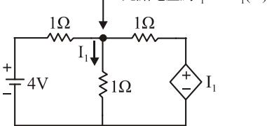
$$\text{故 } \frac{I_1 - 4}{1} + I_1 + \frac{I_1 - I_1}{1} = 0, I_1 - 4 + I_1 = 0$$
