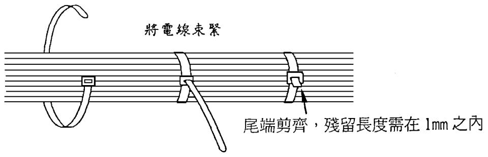
(廿八)PVC 束線的綁線方法，採用雙套節的結紮法來束線，如下圖所示。
