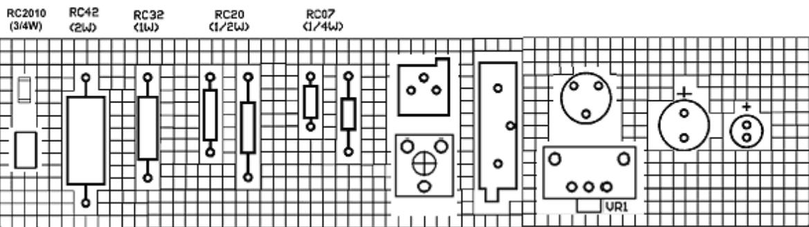
精密可調電阻器 可調電阻器 電解電容器
